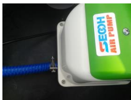
Fig-23 : Raccordement côté surpresseur
